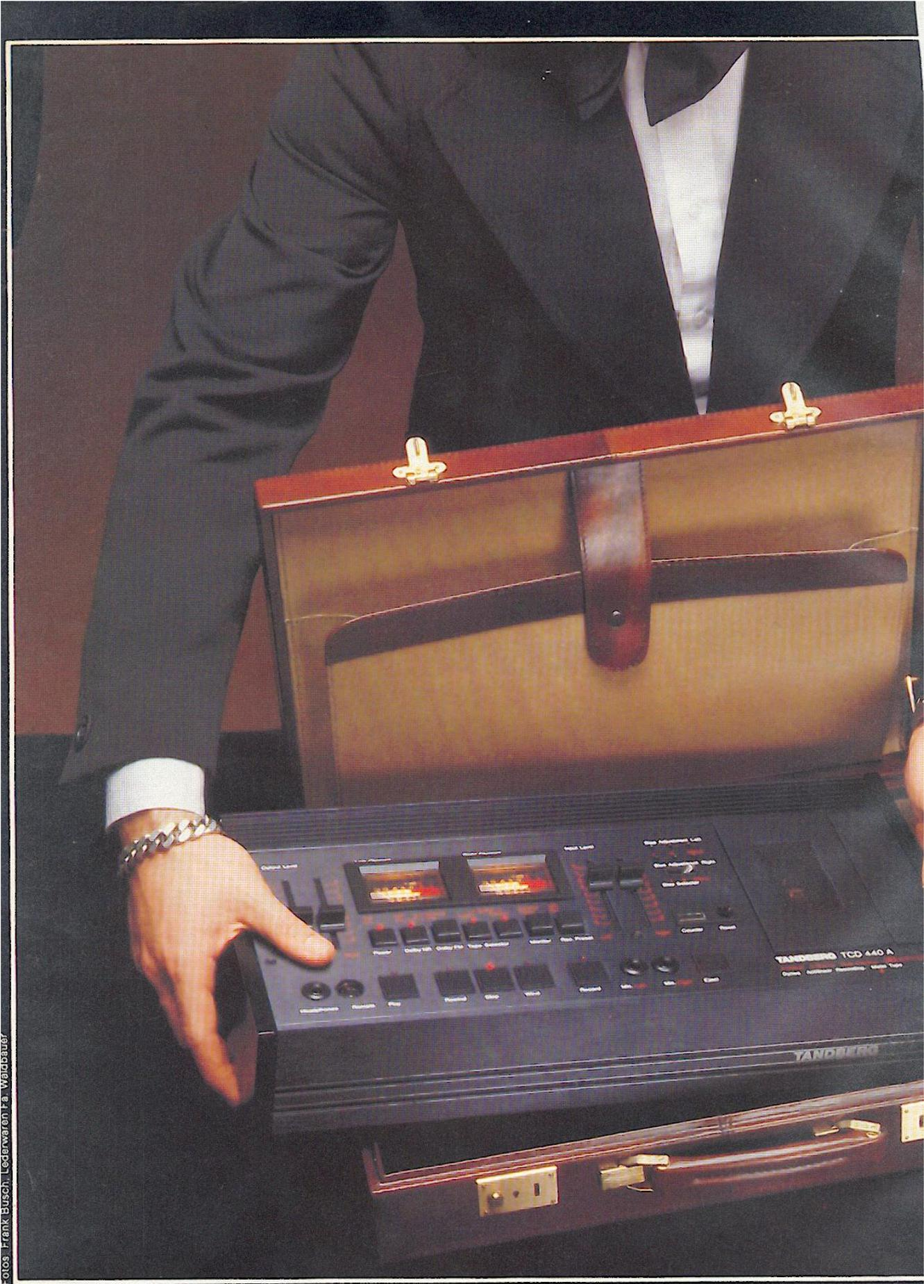
Zwei Tonwellen sorgen für einen optimalen Bandtransport: das Cassettenfach des TCD 440A. Unter der geöffneten Klappe der Azimuth-Regler.
