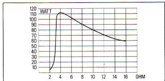
Slik varierer utgangseffekten med den totale høyttalerimpedansen på en kanal
