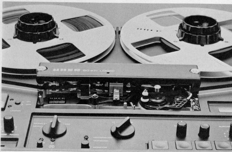
Eine motorisch gesteuerte Rolle sorgt am Capstan für großen Band-Umschlingungswinkel: Uher
