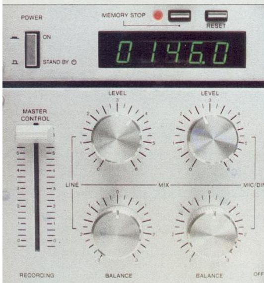
Für den Profi: getrennte Aussteuerungsregler für zwei Eingänge und zusätzlicher Masterregler der Philips
