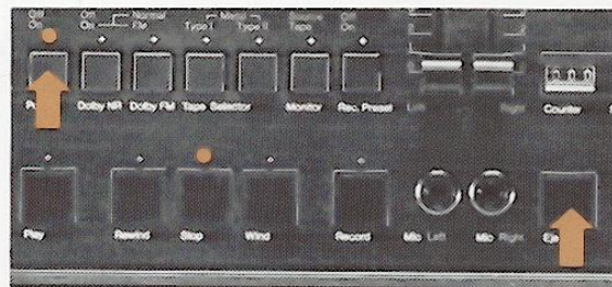
Die Eject-Taste arbeitet nur, wenn die Leuchtanzeige der Stop-Taste aufleuchtet
