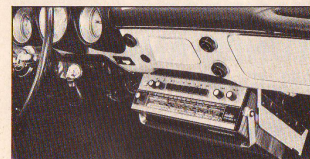
Tandberg Reiseradio TP41 er velegnet også som bilradio. En monteringskassett under dashbordet gir automatisk tilkopling av bilbatteri, bilantenne og eventuell ekstrahøytaler.
