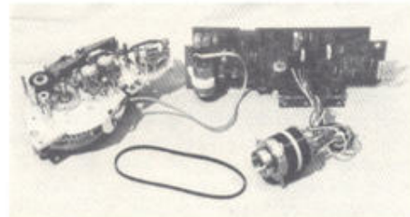
Capstan motor, rem, capstan/svinghjul og servostyringsplaten.
