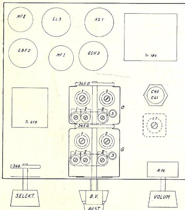
Alle justeringer kan foretas uten å demontere apparatet. Som indikator brukes et tonefrekvens-måleinstrument koblet over uttaket for ekstra høittaler. Instrumentets utslag skal være ca. 0,5 volt. Selektivitetskontrollen skal stå i stilling 2. Volumkontrollen dreies ca.  $\frac{1}{8}$  omdreining tilbake fra maksimum.
