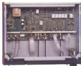
TPA 4036 effektforsterker er bygget opp som en dobbel mono forsterker med én stor ringkjerne transformator. Ikke la deg lure av den beskjedne størrelsen, 4036 er en fullvoksen 2 x 100W forsterker med Zero Negative Feedback konstruksjon og krefter i massevis!
