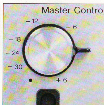
Innspillings-signalene kan reguleres parallelt for begge kanaler med egen Master-kontroll.
