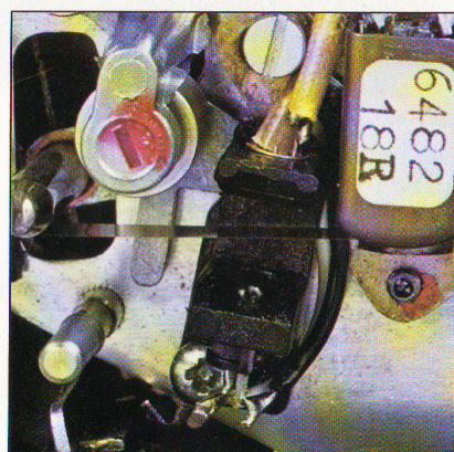
Fototransistoren som styrer den automatiske endestoppen, mottar infrarødt lys fra en lysemitterende diode (LED). Hverken sollys eller lampelys kan derfor gi «falskt» stoppsignal under opptak eller avspilling.
