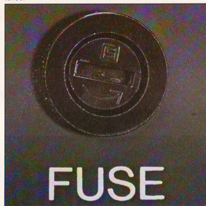
TR 2060 har flere innebygde kretser som sikrer mot overbelastning av enhver art. Selve nettsikringen som bryter ved spenningsfeil sitter lett tilgjengelig i panelet, og kan skiftes uten at apparatet må demonteres.
