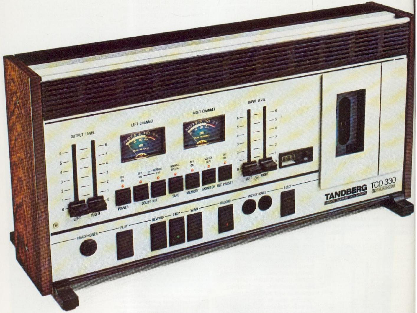
Das TCD 330 ist das Spitzenmodell aus dem Tandberg Cassettenrecorder-Programm, welches in vielen Punkten den Spulenmaschinen entspricht: 3 Köpfe, Hinterbandkontrolle, 3 Motoren, ausnahmslos elektronisch-gesteuert, Fernsteuerung, servo-gesteuertes Umspulen, Doppel-Capstan-Antrieb und Doppel-Dolby\*-Stretcher.
