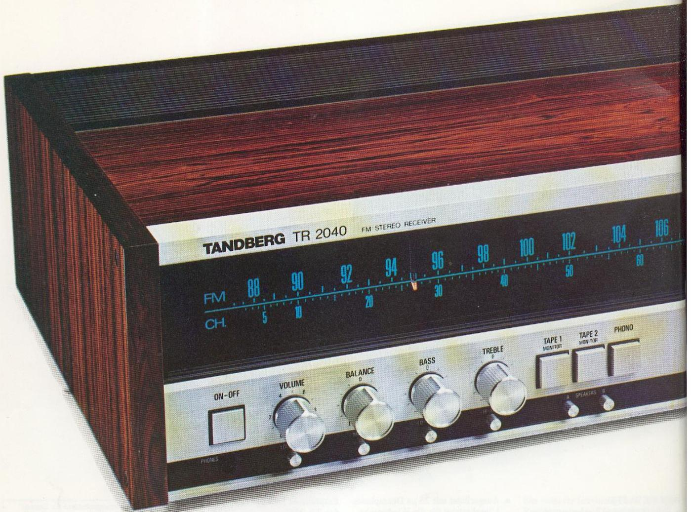
Der TR 2040 ist ebenso ein ausgezeichneten Stereo-UKW-Receiver. Die Ausgangsleistung an 4 Ohm ist größer als  $2 \times 70$  Watt Sinus gemessen nach DIN! Bzw.  $2 \times 40$  Watt Sinus über den ganzen Frequenzbereich von 20 – 20 000 Hz, bei weniger als 0,09% Klirrfaktor. Der UKW-Stereo-Tuner hat zusätzlich Vorwahl für 5 Sender.
