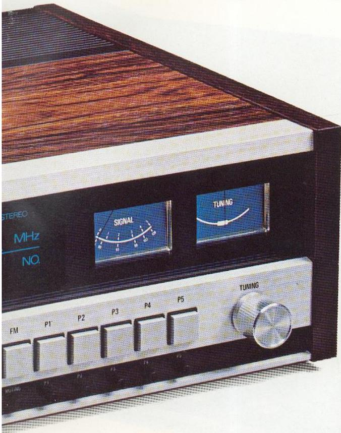
**2 große Anzeigeinstrumente.** Das Feldstärkeinstrument (links) hat zwei Funktionen. Bei manueller UKW-Abstimmung zeigt es bei großem Aussteuerbereich die Feldstärke an. Bei UKW-Vorwahl der 5 Presender dient es als Frequenzanzeige. Das rechte Instrument zeigt den O-Durchgang (Ratio-Mitte).
