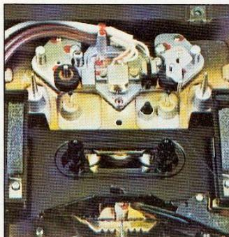
Die 3 speziell entwickelten Motoren garantieren einen zuverlässigen Bandtransport. Bei einem Tonbandgerät ist es ein großer Vorteil, wenn die Zahl der beweglichen Teile auf ein Minimum reduziert wird. Alle mechanischen Teile nutzen sich früher oder später ab; komplizierte Kupplungssysteme und mechanische Verbindungen tragen zu einer Verschlechterung der Betriebsqualität bei.
