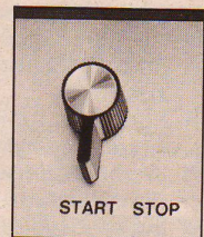
Med venderen START/STOP kan båndet startes og stoppes momentant under inn- og avspilling.
