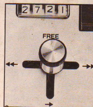
En-spak betjening av hurtig frem- og tilbakespuling og normal fremdrift for opptak og avspilling.
