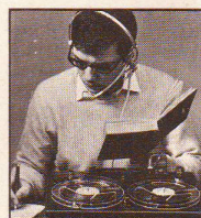
Modell 15SL er ideell for språkopplæring. Opptak kan foretas på nedre spor mens man lytter til læreprogrammet på øvre spor eller omvendt.
