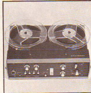
7" spoler kan brukes med åpent deksel, 5" spoler med lukket deksel.
